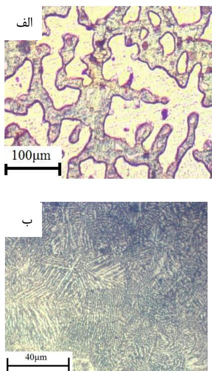
شکل ۳- تصویر میکروسکوپی نوری از (الف) زیرلایه (ب) ناحیه ذوب شده تحت سرعت روبش  $11/5 \text{ mm/s}$ ، انرژی پالس  $9 \text{ J}$ ، عرض پالس  $6 \text{ ms}$  و بسامد پالس لیزر  $20 \text{ Hz}$ .
