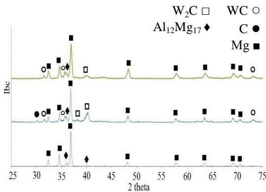
شکل ۴- الگوی پراش پرتو X (الف) زیرلایه (ب) پوشش حاصل از فرایند APS (ج) ناحیه ذوب شده تحت سرعت روبش  $11/5 \text{ mm/s}$ ، انرژی پالس  $9 \text{ J}$ ، عرض پالس  $6 \text{ ms}$  و بسامد پالس لیزر  $20 \text{ Hz}$ .
