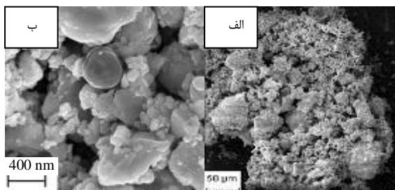
شکل ۱- مورفولوژی پودر WC-Co در دو بزرگنمایی مختلف
