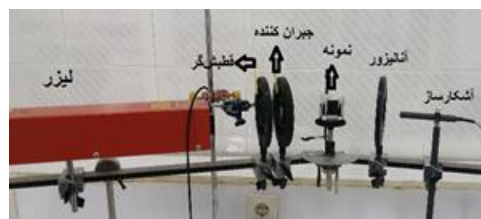
شکل ۲: تصویر از چیدمان آزمایشگاهی بیضی‌سنجی نول
