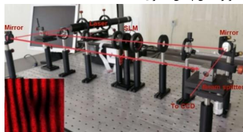
شکل ۶: چیدمان تداخل‌سنج ماخ‌زندر و در سمت چپ، الگوی چنگالی به دست آمده از تداخل‌سنج ماخ‌زندر نشان دهنده‌ی بار توپولوژیکی l=1 .
