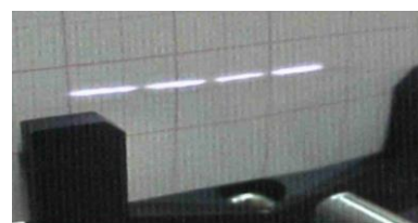
شکل (۵) الگوی میدان نزدیک بزرگنمایی شده پرتو لیزر
