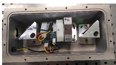
شکل ۲: چیدمان آزمایشگاهی لیزر فرابنفش ۲۶۶ نانومتری (شکل بالا) و تصویر بخش هماهنگ چهارم (شکل پایین).
