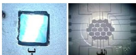
شکل ۳: (الف) تصویری از الکترود های شش ضلعی به همراه دیواره (ب) دیافراگم پلیمری
