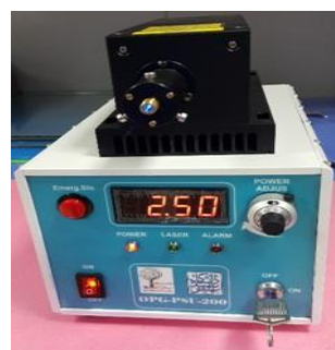
شکل ۴: تصویر لیزر ساخته شده برای کاربردهای اپتوژنتیکی در آزمایشگاه اپتوژنتیک
