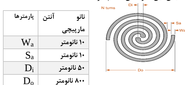
شکل (۲) ساختار نانو آنتن مارپیچی جدول (۱) پارامترهای نانو آنتن
