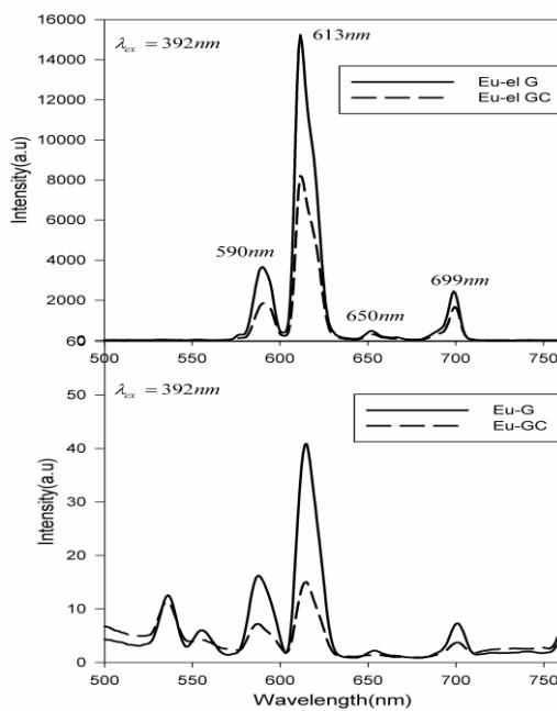
شکل ۴: طیف گسیلی نمونه‌های آلاییده به  $Eu^{3+}$  (تحریک در طول موج ۳۹۲ nm)
