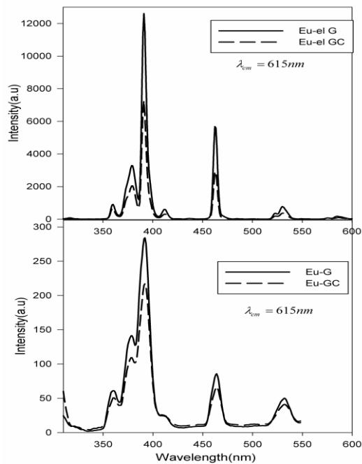
شکل ۳: طیف برانگیختی شیشه و شیشه- سرامیک(پایین) و شیشه و شیشه- سرامیک دز خورده آلاییده به  $\text{Eu}^{3+}$  (دیدهبانی شده در nm .۶۱۵)
