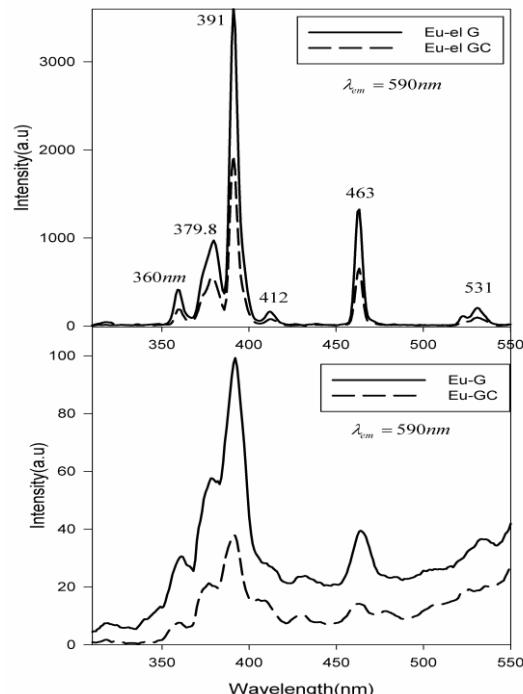
شکل ۲: طیف برانگیختی شیشه و شیشه- سرامیک(پایین) و شیشه و شیشه- سرامیک دز خورده آلاییده به  $\text{Eu}^{3+}$  (دیدهبانی شده در nm .۵۹۰)
