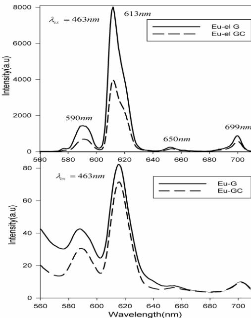
شکل ۵: طیف گسیلی نمونه‌های آلاییده به  $Eu^{3+}$  (تحریک در طول موج ۳۹۲ nm)
