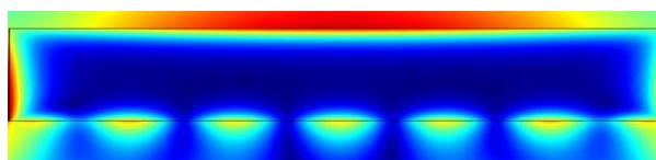
شکل ۲: پلاسمون‌های سطحی تشکیل شده در محل اتصال دو ماده گالیوم آرسناید و طلا
