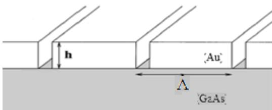
شکل ۱: ساختار آشکارساز نوری سدشاتکی
