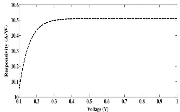
شکل ۵: پاسخدهی نوری آشکارساز بر حسب ولتاژ
