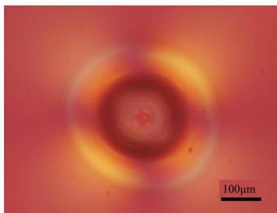
شکل ۴) طرح کونوسکوپیک تولید شده زیر میکروسکوپ پلاریزان.
