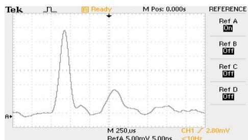
شکل ۵: تپ خروجی لیزر برای سامانه اپتیکی ۲۰-۲۰
