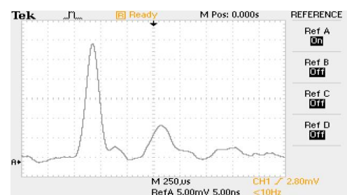
شکل ۵: تپ خروجی لیزر برای سامانه‌ی اپتیکی ۲۰-۲۰
