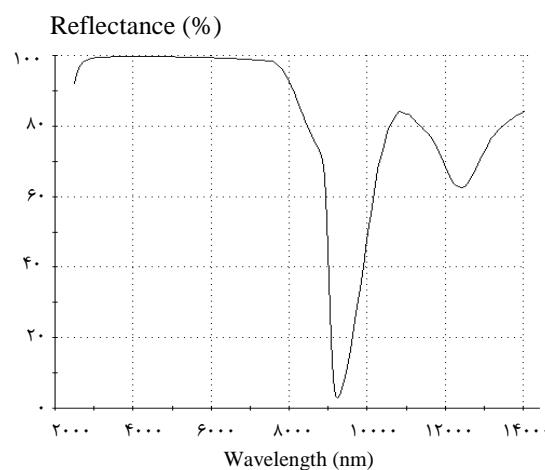
شکل ۱: منحنی بازتاب آینه کامل ۳-۵ میکرومتر. افت شدید انعکاس در بازه‌ی طول موجی ۹۰۰۰ نانومتر به اثرات جذبی  $\text{SiO}_2$  مربوط می‌باشد. طراحی و شبیه‌سازی توسط نرم افزار طراحی لایه‌های نازک انجام شد.
