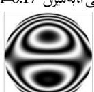
شکل ۷، الگوی تداخلی، حصل از کج شدن عدسی ۲، به میزان ۰.۱۷°
