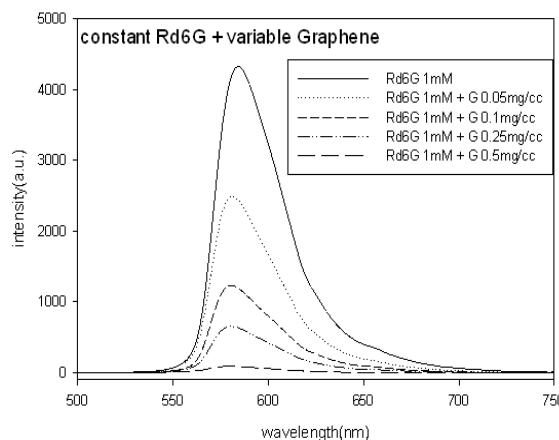
شکل ۲ : طیف فلوئورسانس ردامین 6G با غلظت ثابت  $1\text{mM}$  در حضور غلظت های مختلف گرافن
