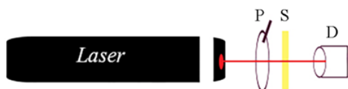
شکل ۱: چیدمان اپتیکی برای سنجش چگالی نوری بافت تومورهای مغزی. (P) قطبشگر، (S) نمونه مورد آزمایش و (D) آشکارساز.
