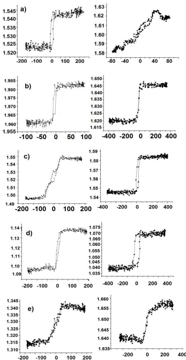
شکل ۲: حلقه پسماند طولی نمونه (سیگنال کر طولی نمونه واحد دلخواه) بر حسب میدان مغناطیسی (واحد ارستد) در حالتیکه میدان در عرض نمونه است (سمت راست) و حالتیکه میدان در طول نمونه است (سمت چپ) برای جریان ۸۰<sup>(a)</sup>، ۱۲۰<sup>(b)</sup>، ۱۶۰<sup>(c)</sup>، ۲۰۰<sup>(d)</sup> و ۲۴۰<sup>(e)</sup> میلیآمپر.
