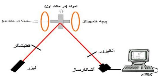
شکل ۱: چیدمان کر نمونه در حالتی که میدان در عرض نمونه است
