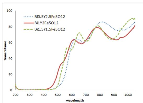
شکل ۲: طیف تراگسیل فیلم‌های نازک گارنت بازپخت شده در دمای ۷۰۰ درجه سلسیوس.
