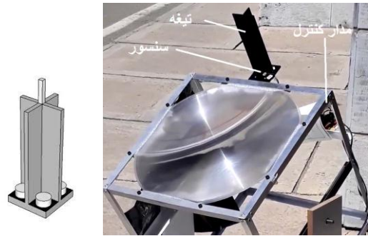
شکل ۱- مدار کنترل و حسگر سامانه ردیاب
