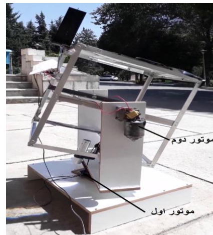
شکل ۲- ساختار مکانیکی ردیاب
