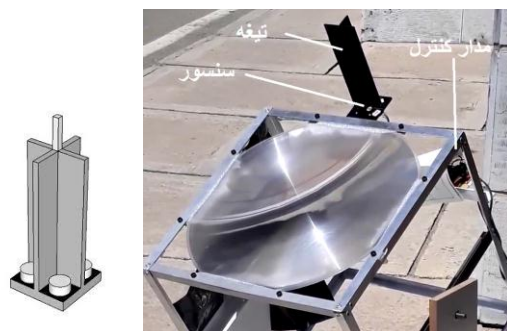
شکل ۱- مدار کنترل و حسگر سامانه ردیاب
