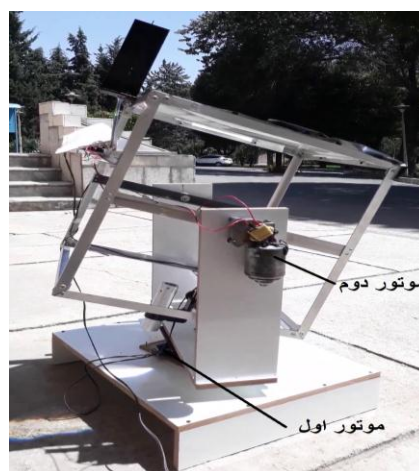
شکل ۲- ساختار مکانیکی ردیاب
