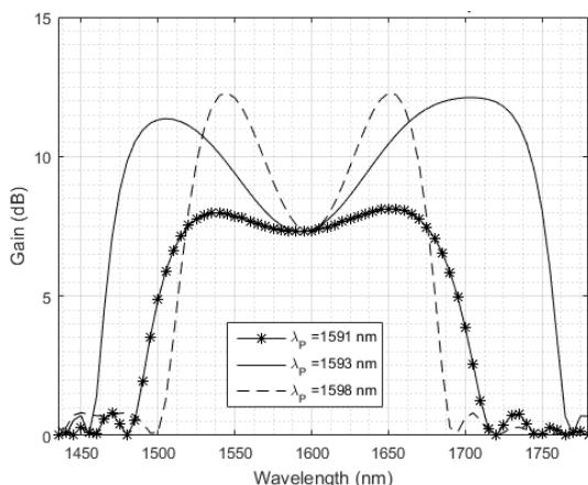
شکل ۳: نمودار بهره تقویت کننده بر حسب طول موج به ازای طول فیبر ۱ m و توان پمپ ۴ W و طول موج‌های مختلف پمپ
