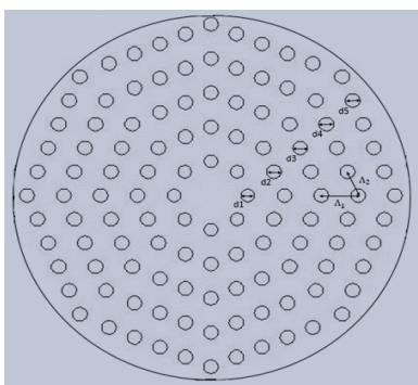
شکل ۱: ساختار و سطح مقطع فیبر بلور فوتونی
