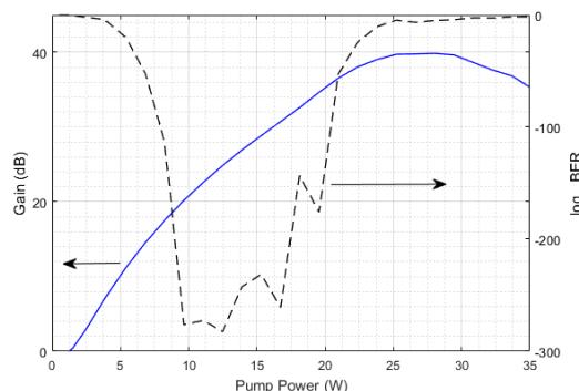
شکل ۵: بهره سیگنال بر حسب توان پمپ در طول موج سیگنال nm ۱۵۹۵، طول فیبر ۱ m و طول موج پمپ ۱۵۹۵ nm.
