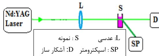
شکل ۲: چیدمان اندازه‌گیری بیناب فلورسانس رنگ رودامین B با و بدون نانوکلوجیدهای فلزی.
