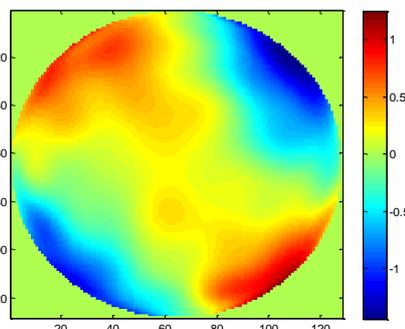
شکل ۱: صفحه فازی تولید شده با استفاده از چندجمله‌ای های زرنیک برای  $D/r_0$  واحد شامل جملات ۲ تا ۱۲۸ زرنیک برای تعداد نقاط شبکه  $128 \times 128$ .
