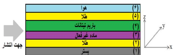
شکل ۱- ساختار تلفیق‌کننده پلاسمونی جذب کننده. تلفیق‌کننده مورد بررسی شامل دو لایه طلا یک لایه باریم تیتانات، یک لایه از ماده غیرفعال سیلیکون نیترید و یک لایه نیمه متناهی از هوا و بستری نیمه متناهی از سیلیکا گذاخته شده می‌شود.
