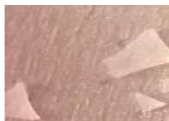
شکل ۶- سطح نمونه پس از بهبود با  $TiCl_4$  پس از شستشو با اتانول با بزرگنمایی ۴۰۰ برابر
