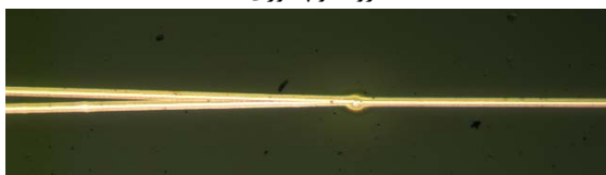
شکل ۷: نمایی از اتصال Y خروجی ماسک با میکروسکوپ 10x.
