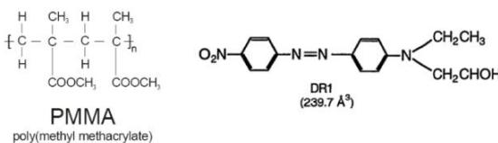
شکل ۳: ساختار شیمیایی پلیمر PMMA و رنگینه‌ی DR1 (۲۳۹.۷ Å³)
