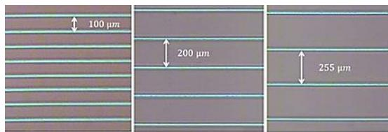
شکل ۵: نمونه‌ای از توری‌های ایجاد شده بر روی هسته‌ی موجبر که توسط لنز ۴x میکروسکوپ نوری گرفته شده است.
