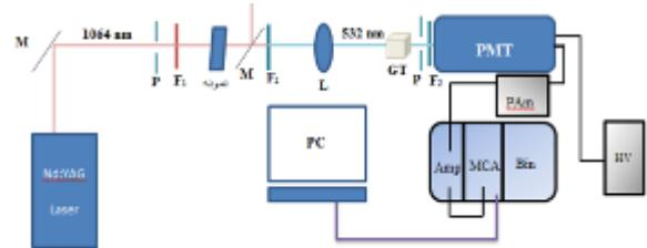
شکل ۱: شمای کلی از چیدمان تجربی (M: آینه با بازتابندگی بالای ۱۰۶۴ نانو متر، L: لنز، P: حفره دریچه، F1: فیلتر میان گذر ۵۳۲ نانومتر، F2: فیلتر میان گذر ۳۳۰ نانومتر، GT: منشور گلن-تیلور، PMT: آشکار ساز، HV: منبع ولتاژ بالا، PAm: پیش تقویت کننده، Amp: تقویت کننده، MCA: تحلیلگر چند کاناله، PC: رایانه).
