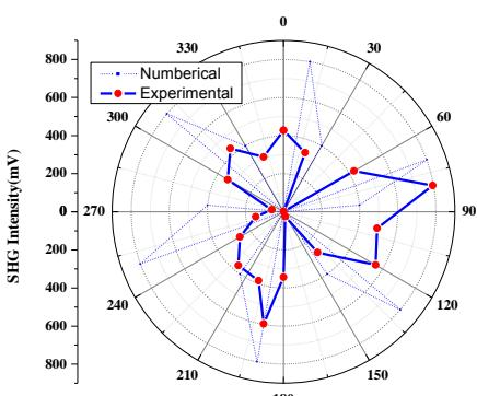
شکل ۲. نمودار وابستگی شدت SHG در میدان H صفر به زاویه سمتی نمونه گارنت در ترکیب قطبش ورودی و خروجی P. نمودار نقطه‌چین حاصل از پیش‌بینی تئوری این نتایج است.
