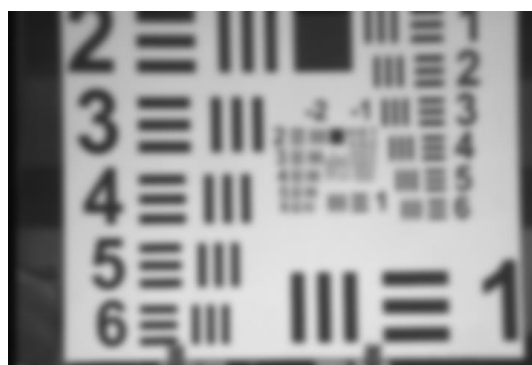
شکل ۱۱: تصویر الگو در دمای 1100^{\circ}\text{C} درجه سانتی‌گراد
