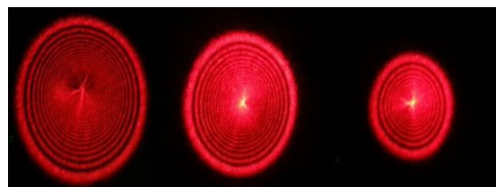
شکل ۴: الگوی شدت پرتو هلیوم-نئون پس از عبور از پلی استر به ترتیب از چپ به راست به ازای \omega = 0, 5, 10 \text{ Hz}
