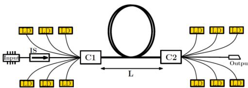
شکل ۱: پیکره بندی یک تقویت‌کننده‌ی فیبری نمونه که از دو طرف پمپ شده. L: طول فیبر YDDC. C1 و C2: کوپلرهای ورودی و خروجی. LD: لیزر دیودهای پمپ. IS: ایزولاتور ورودی.
