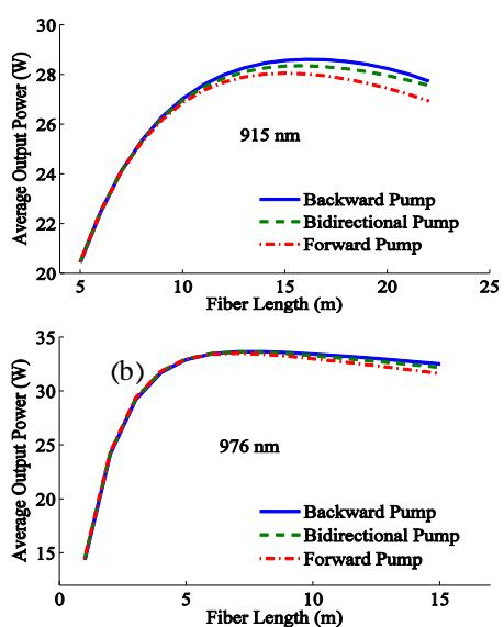
شکل ۵: توان متوسط خروجی بر حسب طول فیبر YDDC برای طول موج پمپ (a)  $\lambda_p = ۹۷۶\text{-nm}$  (b)  $\lambda_p = ۹۱۵\text{-nm}$  و توان پمپ .۴۰-W
