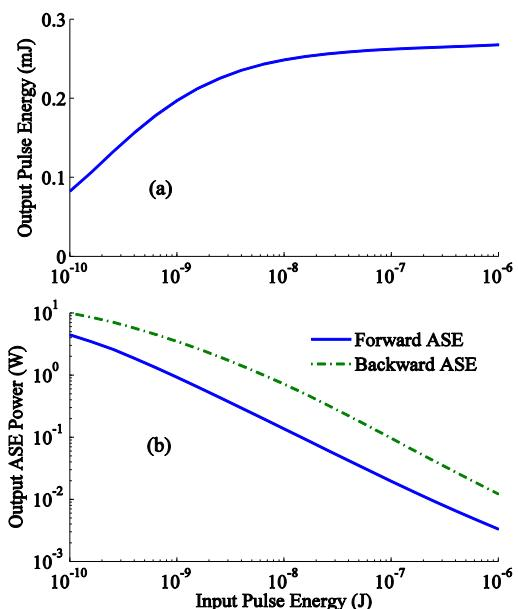
شکل ۴: نمودار (a) انرژی پالس خروجی تقویت‌کننده (b) گسیل خود به خودی تقویت شده خروجی رو به جلو و رو به عقب، بر حسب انرژی پالس ورودی.
