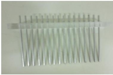
شکل ۱: مجموعه پین‌های آند نصب شده بر روی پلکسی گلاس
