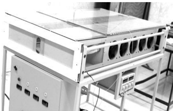
شکل (۲) نمونه ساخته شده از محفظه شیشه ساز تلاطم جوی در آزمایشگاه انتشار پرتو لیزر در جو
