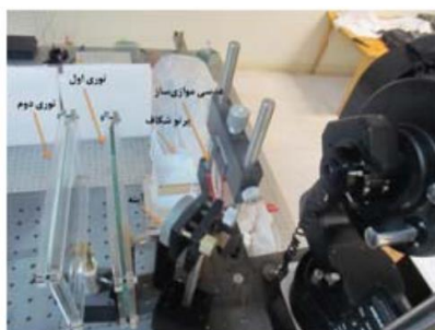
شکل ۱: چیدمان آزمایش به همراه نمای بزرگ شده حسگر ماره‌ای دو کاناله‌ی جبهه‌ی موج
