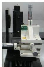
شکل ۱۱: در سامانه دو لنزی، لنز جلوئی ثابت و لنز پشتی در نگهدارنده با قابلیت چرخش و قابلیت جایه جایی جانبی بسته شده است
