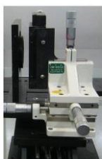
شکل ۱۱: در سامانه‌ی دو لنزی، لنز جلویی ثابت و لنز پشتی در نگهدارنده‌ی با قابلیت چرخش و قابلیت جابه‌جائی جانبی بسته شده است
