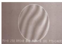
شکل ۱۶: الگوی تداخلی حاصل از آزمون MTF بر روی سامانه‌ی تصویربرداری پس از انجام تنظیمات
