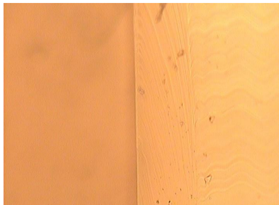
شکل ۳: تصویر نوری از پیوند بین دو لایه پلیمر پلی‌دی‌متیل-سیلوکسان خالص و ترکیب پلیمر و نانوسیم‌ها به روش پیوند پلاسمایی.
