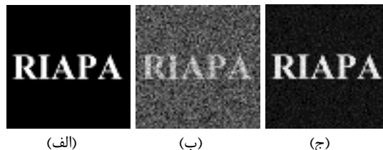
شکل ۲: تصاویر حاصل از شبیه‌سازی عددی. الف) تصویر اصلی. ب) تصویر گوست به روش محاسباتی مرسوم. ج) تصویر گوست به روش گزینشی.
