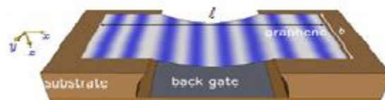
شکل ۱: صفحه گرافن معلق روی یک شیار در یک بستر عایق. یک اتصال فلزی برای به حرکت در آوردن صفحه گرافن استفاده شده است.
