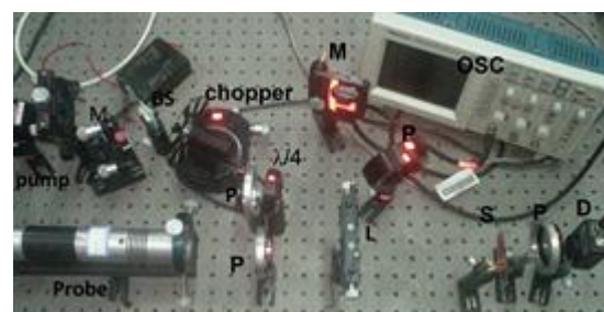
شکل ۲: PS: پلاریزور، LS: لنز، MS: آینه، S: نمونه، F: فیلترسبز، PD: آشکارساز، OSC: اسیلوسکوپ، BS: شکافنده پرتو.
