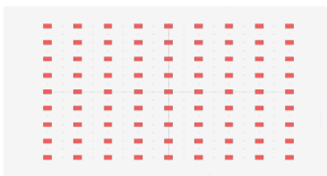
شکل ۲) ساختار مربعی بلور فوتونی دو بعدی با شکل میله‌های مربعی
