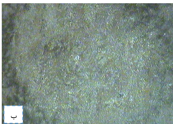
شکل ۳: مقایسه کیفی کندگی برای حالت الف) دوپالسی ب) تک پالس برای نمونه آلومینیوم (حالت موازی)
