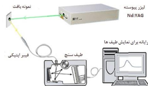
شکل ۱: طرحواره‌ی از سیستم آزمایشگاهی انجام طیف‌سنجی به روش فلورئورسانس القایی لیزری بر روی بافت سالم و سرطانی.
