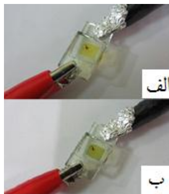
شکل ۲: نمونه‌ی سیستم الکتروکرومیک (الف) در ولتاژ صفر، (ب) در ولتاژ ۲ ولت.
