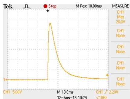
شکل ۶- تصویر مشاهده شده از عملکرد لیزر در فرکانس ۱ هرتز با انرژی ۴/۱ ژول توسط اسیلوسکوپ
