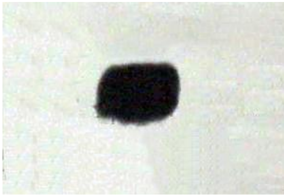
شکل ۹: مقطع لکه لیزر بر روی کاغذ حرارتی با ابعاد تقریبی ۱۰ در ۸ میلی‌متر ناشی از اثر ۱۰ پالس متوالی
