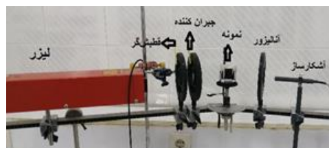
شکل ۲: تصویر از چیدمان آزمایشگاهی بیضی‌سنجی نول
