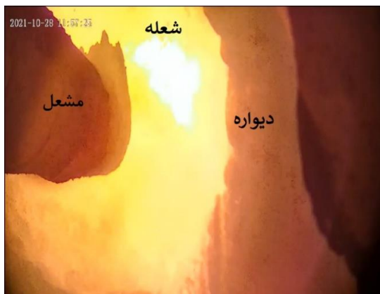
شکل ۶: تصویر گرفته شده از داخل کوره سیمان سبزوار توسط دوربین حرارتی دما بالا. مشعل، شعله و دیواره کوره در این عکس دیده می‌شوند.
