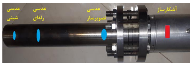
شکل ۴: تصویر نهایی دوربین. محل عدسی‌های مختلف درون دوربین توسط بیضی‌ها آبی و محل آشکارساز توسط مستطیل قرمز مشخص شده است.
