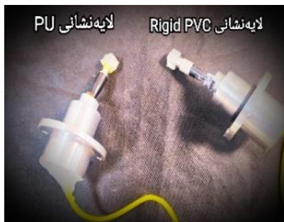
شکل ۲: حسگرهای تار نوری فابری-پرو آماده شده برای قرارگیری در محفظه خلاء
