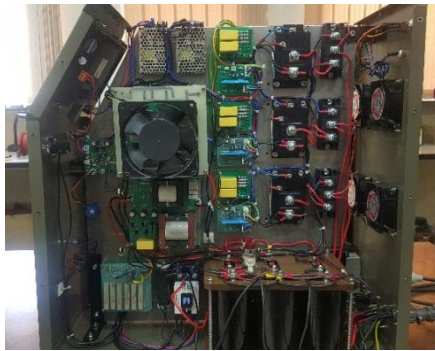
شکل ۲: تصویر منبع تغذیه پالس مربعی نوعی ساخته شده برای لیزر Nd:YAG با انرژی خروجی یک ژول.
